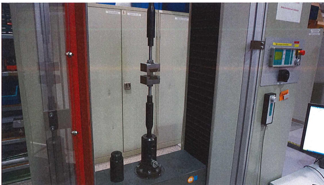
Bild 1 Beispielhafte Darstellung des Prüfaufbaus Zugversuch, kalottische (biegemomentenfreie) Adaption der Gewindeklöppel
