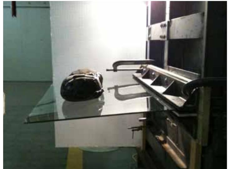
Abbildung 2: Überdachungstest - Gebrochener Verbund - Saflex® DG - 34 kg HS-Glas gleicher Temperatur aufweist.
