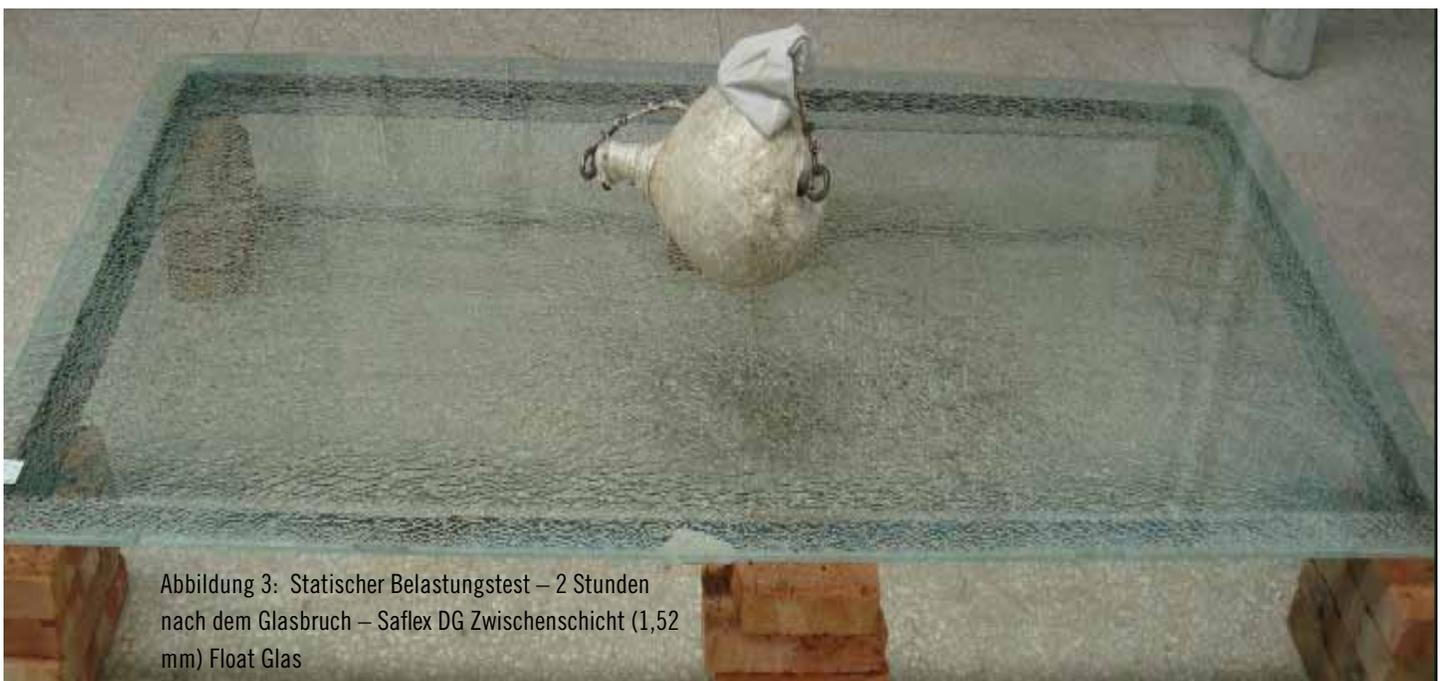
Abbildung 3: Statischer Belastungstest – 2 Stunden nach dem Glasbruch – Saflex DG Zwischenschicht (1,52 mm) Float Glas
